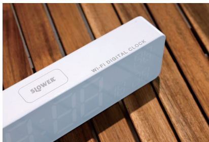
上部SLOWERロゴマークはLEDの輝度調整とスヌーズをコントロールできるタッチセンサーになっています。
