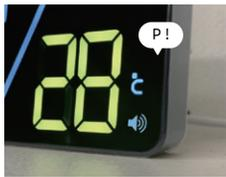
室温が28°Cを超えると温度表示がオレンジ色に変化し熱中症などの危険を警告します。毎分"P"とアラート音でも警告します。
