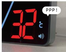
室温が32°Cを超えると温度表示が赤色に変化し熱中症などの危険を警告します。毎分"PPP"とアラート音でも警告します。
